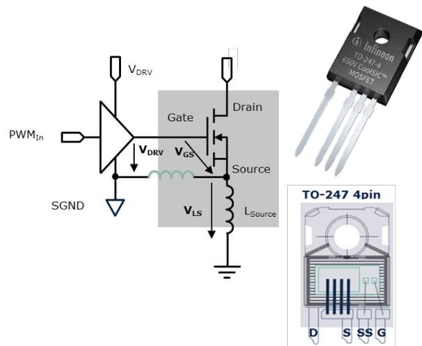
Fig. 10: Novel TO-247-4pin package
