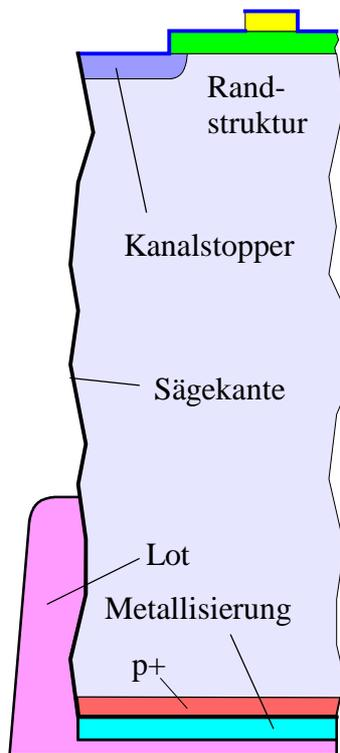
**Abb. 2:** Chiprand eines NPT-IGBT's
